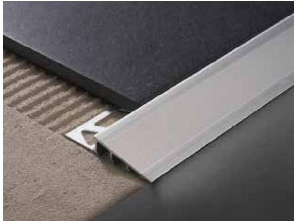
RAMPTEC ZRR es un perfil de aluminio anodizado diseñado para unir pavimentos no coplanares. El ángulo de inclinación, de unos 20°, crea una conexión suave entre el desnivel, permitiendo un paso seguro entre los dos pavimentos. El perfil en el lado vertical dispone de la característica ranura patentada de "cola de milano" para un mejor anclaje mecánico con la cola y la junta, en el punto de mayor tensión.
